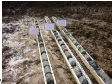
Рис.6. а) измерение диаметра грунтоцементной колонны; б) керны, выбуренные из тела
