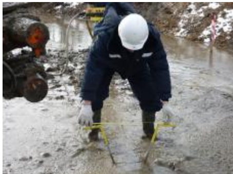
Рис.6. а) измерение диаметра грунтоцементной колонны; б) керны, выбуренные из тела
